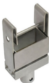
"FINCH" WET TENSILE TEST TAPPI T 456 om-03
