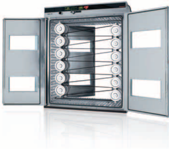
Horno de paso continuo con modo de funcionamiento en línea (franja lateral de carga y descarga)
