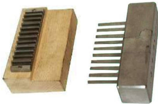
Dispositivo para el pegado de las crestas de las muestras de papel acanaladas a la cinta adhesiva
