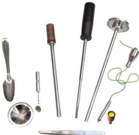
**Espátula y embudo** de alimentación pellets, **Boquilla** de 2,095 mm de Ø de Carburo de Tungsteno, **Herramienta de limpieza** de la boquilla, **Pistón**, **Útil de limpieza** del cilindro, **Útil de Extrusión**, **Plomada**, **Nivel de Burbuja** y **Pinzas**.
