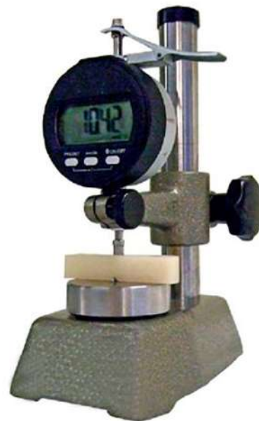
Cod. 3490 MICROMETRO DIGITAL MIP-20D (resolución 0,01mm) Verificación profundidad de las entallas en "V"
