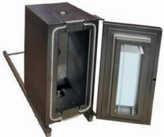
CAMARA TERMICA DE ENSAYOS con insertos desmontables para desplazar con facilidad el bastidor y con bisagras especiales (con prolongación) para no incrementar las dimensiones del bastidor en caso de apertura de la puerta frontal
