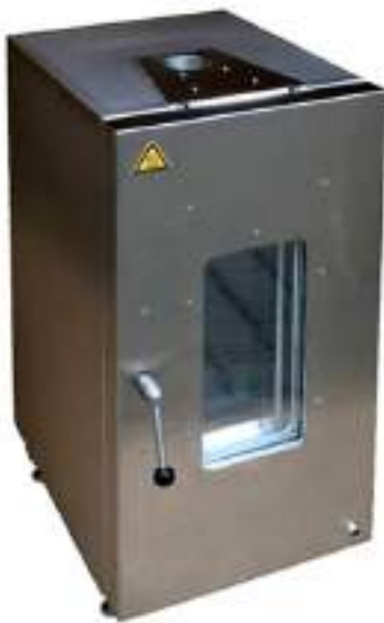
CAMARA ENSAYOS TERMICOS con insertos desmontables para desplazar con facilidad el bastidor
