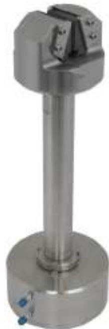
Mordazas Neumáticas de 10 kN para rango ente -70°C y +350°C
