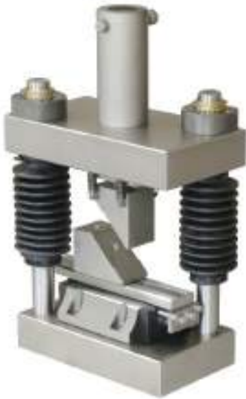
Dispositivo de prueba de cizallamiento por compresión a 45° (ASTM-D1037-Fig.31)
