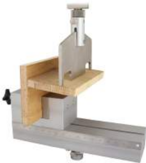
Dispositivo de ensayos de flexión especial para ensayar uniones de muebles (DIN 68501)
