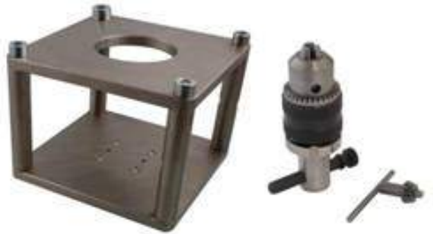
Dispositivo especial para probar la resistencia a la extracción de clavos de paneles de madera. (ASTM-D1037-Fig. 13 (§§13-15))
