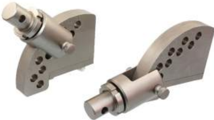
Ensayo Arcan Medición de las propiedades de cizallamiento de la madera clara
