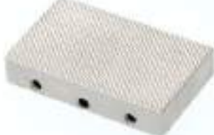
BP picadas (pirámides) Mandíbulas Picadas - Pirámides 1.2x45° - Acero endurecido 58 HRC - Niqueladas
