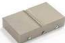
BV p/probetas redondas Mandíbulas en V - Para todo tipo de probetas redondas - Paso diente 1.2 mm - Acero endurecido 58HRC - Niqueladas
