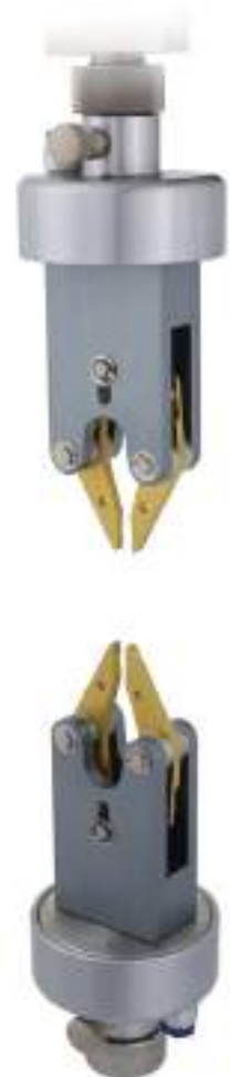
Mordazas con recubrimiento de TitanNitride
