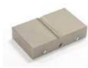
BV p/probetas redondas Mandíbulas en V - Para todo tipo de probetas redondas - Paso diente 1.2 mm - Acero endurecido 58HRC - Niqueladas
