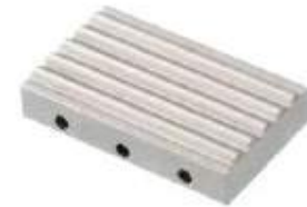
BW mandíb. onduladas Mandíbulas Onduladas - Para Materiales Flexibles - Ondas de 5 mm - Acero endurecido 58HRC - Niqueladas
