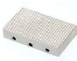
BP picadas (pirámides) Mandíbulas Picadas - Pirámides 1.2x45° - Acero endurecido 58 HRC - Niqueladas
