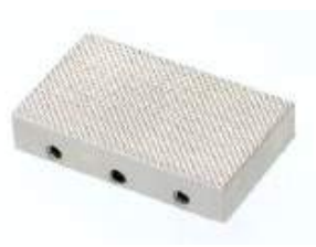
BP picadas (pirámides) Mandíbulas Picadas - Pirámides 1.2x45° - Acero endurecido 58 HRC - Niqueladas
