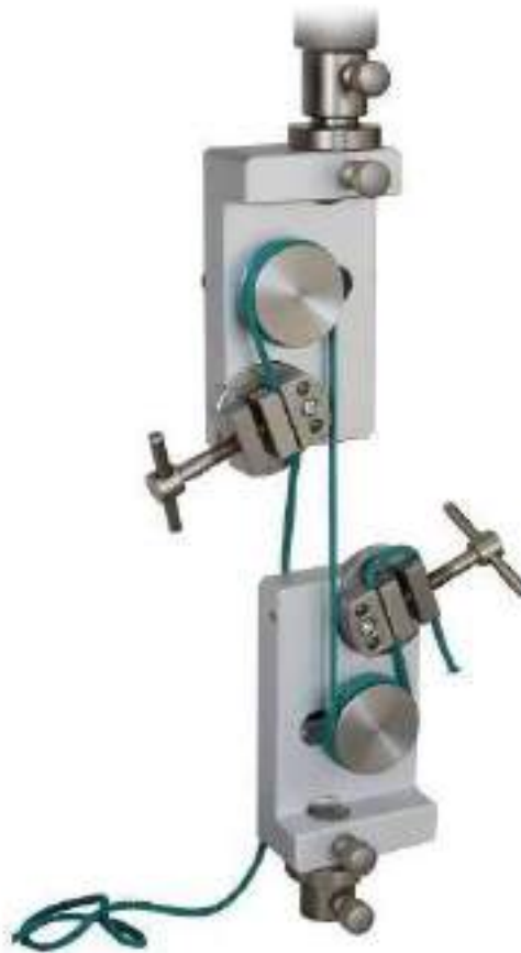
MB-N/5-VI+BD+D40 Ángulo de mandíbula y distancia desde el bolardo hasta la línea central ajustable
