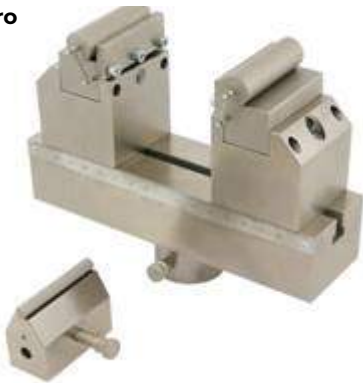
Ponte de flexión modelo PFL.m/St-360 con barra de 360 mm de longitud acuerdo con ASTM E399 para probar la tenacidad a la fractura por deformación plana lineal-elástica K IC de materiales metálicos
