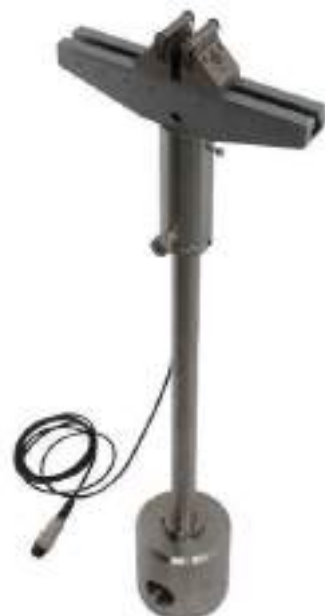
PFb/4P-CWXD8-iTH1-AfDP10s iTH1 Adaptador para cámara ensayos a diferentes temperaturas con sensor inductivo
