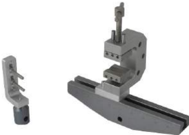
Soporte de jeringa especial para el ensayo de doblado de 90 °
