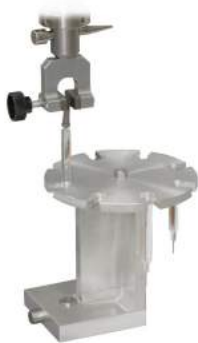
(soporte de jeringa) + (mordaza superior) Accesorio especial para medir la fuerza de extracción de las puntas de la tapa de la aguja
