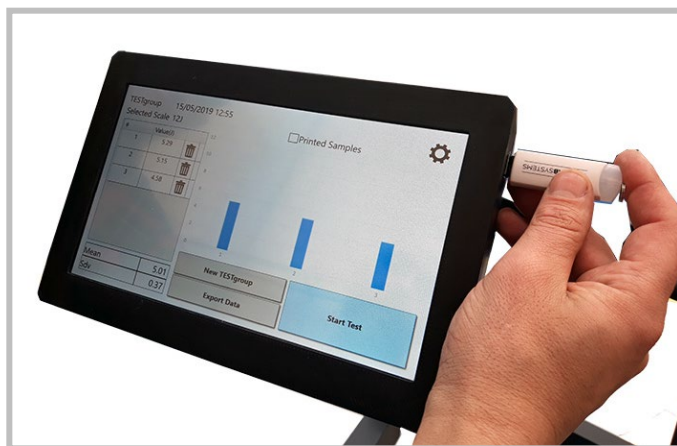
Puerto USB salida datos a memoria USB
