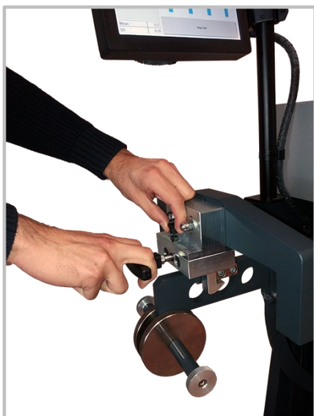
Sistema liberación péndulo de seguridad
