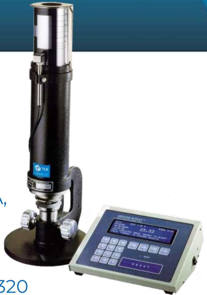
Para determinar de forma rápida y precisa la Lisura, Porosidad al aire y la Dureza en el papel y cartón mediante el método GURLEY
