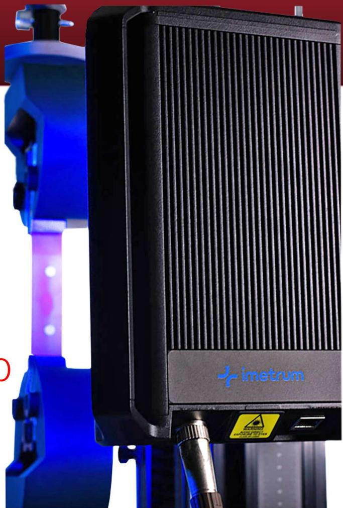
Adaptable a Máquinas Universales de Ensayos para medir con precisión las deformaciones entre puntos de las probetas sometidas a esfuerzos de tracción y para determinar el módulo de elasticidad o módulo de Young, límite elástico, alargamiento a la rotura de la probeta.
