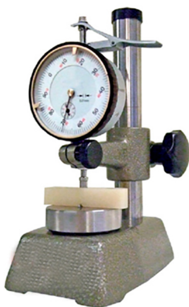
MICROMETRO ANALOGICO MIP-20 (resolución 0,01mm) Verificación profundidad de las entallas en "V"
