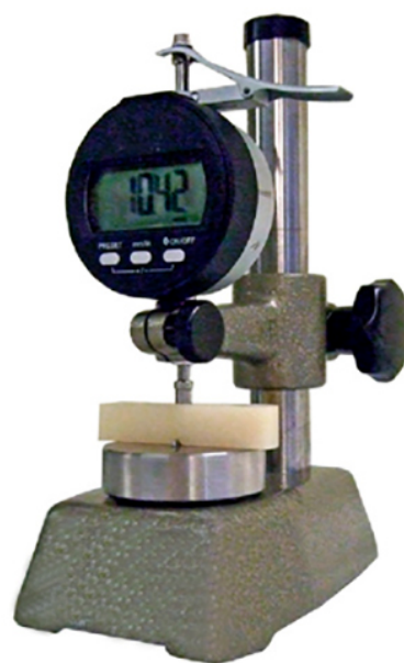
MICROMETRO DIGITAL MIP-20D (resolución 0,01mm) Verificación profundidad de las entallas en "V"
